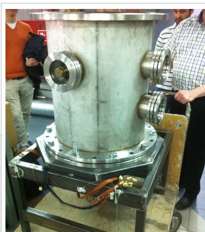
Kapsuła testowa symulująca warunki panujące na dużych wysokościach
